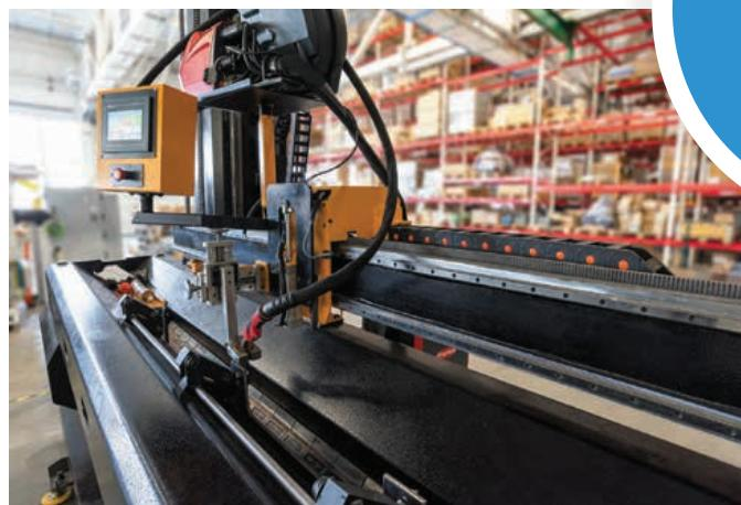
TIG, MIG/MAG і зварювання під флюсом. Обрати зварювальні програми та контролювати основні параметри процесу зварювання дозволяє контролер ЧПУ з кольоворовим сенсорним дисплеєм. Також в установці реалізовано систему відведення тепла у вигляді мідної підкладки, що веде до мінімізації викривлення заготовлі та поліпшення структури зварного шва і навколошовної зони. Прокладка має подовжню канавку, завдяки якій формується зворотний
