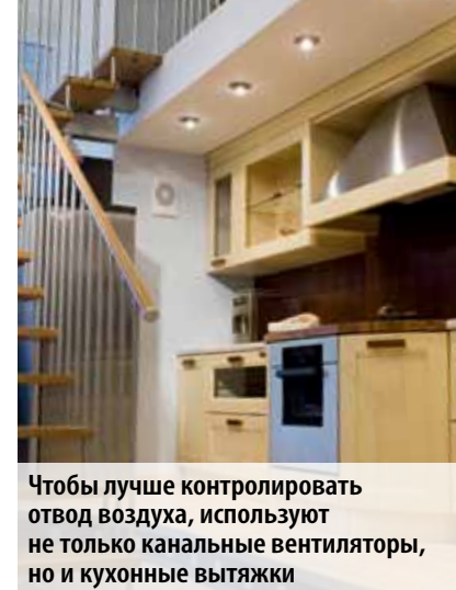
Стеновые проветриватели состоят из пропеллера, фильтра, устройства для изменения количества подаваемого воздуха. Возможно использование нагревателя и рекуператора
