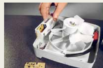
1 Собирают вентилятор, устанавливают систему автоматики
